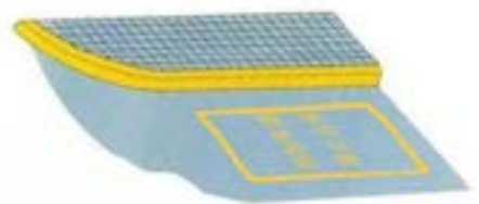
消防车通道路侧禁停标线及路面警示标志示例
